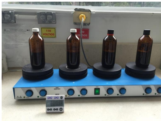
Homogeneizado de los extractos en plancha de agitación
